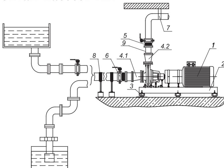
Агрегат устанавливается на бетонном полу толщиной не менее 100 мм (рис. 1). Поверхность бетонного пола должна быть горизонтальной и ровной.
