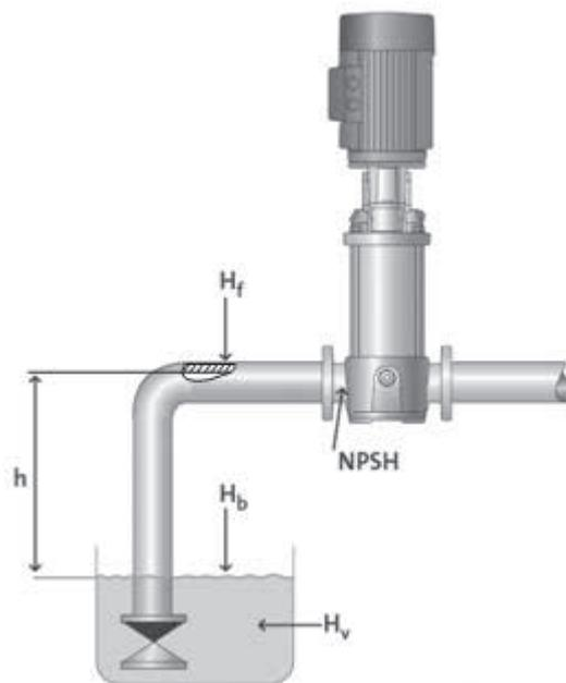
1. Определить значение NPSH<sub>a</sub>, обеспечиваемое гидравлической системой на входе насоса:
